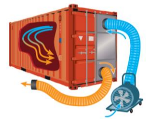
Système demi-porte : Apport d'air à une débit d'environ 1 500 m 3 / h
