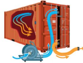
Système entrebâilleur : Apport d'air à une débit d'environ 600 m 3 / h
